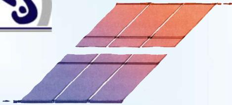
Das Schwimmbadwasser kann die OKU-Absorber in jeder Richtung durchströmen. Die Montage ist sowohl der Länge als auch der Breite nach möglich. Anschluß der einzelnen Absorberreihen nach Tichelmann (gleiche Leitungswege für jede Reihe). Wir empfehlen, nicht mehr als acht Absorber hintereinanderschalten.
