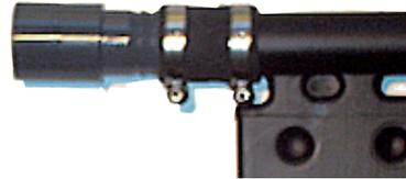
4. Entlüfter (8): Der Entlüfter muß in senkrechter Stellung an höchster Stelle montiert werden. Reduzier-T-Stück und Reduzierstück einkleben und Entlüfter mit Teflonband einschrauben.
