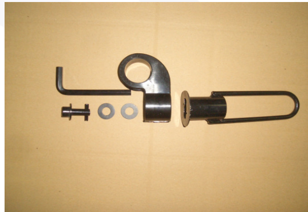
Abbildung I Verankerung der Bedachung mit Schloss – von rechts nach links: Zur Einbetonierung bestimmte Verankerung, Kunststoffteil der Verankerung, Schaumeinlage, Schloss, Inbusschlüssel.
