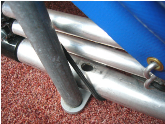
Abbildung H Befestigung der Abdeckplane an den Bügel mit Klettverschlüssen.
