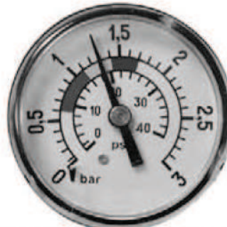
1,3 kg/cm 2 - 18,5 PSI: Der Druck beträgt 0,5 kg/cm 2 mehr als der Anfangsdruck. Das bedeutet, dass eine REINIGUNG notwendig ist.
