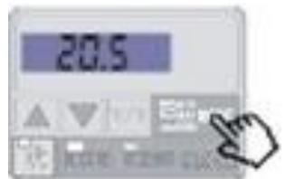
7. Taste »▲« drücken, bis der Wert »t03« angezeigt wird.
