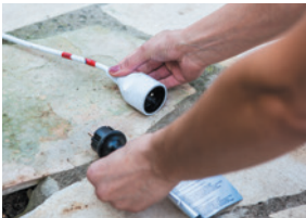
1) Trennen Sie die Pumpe
