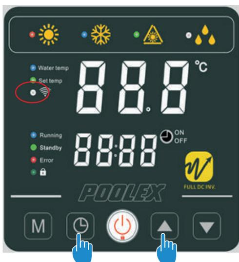
Drücken Sie + gleichzeitig für 3s, blinkt schnell, die Steuerbox ist bereit zum Pairing.
