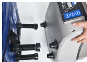
3) Lösen Sie die 3 Anschlüsse vom Motorblock.
