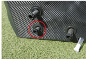
8) Bringen Sie die 3 Anschlüsse dieses Liners aus den dafür vorgesehenen Räumen. Die kürzeste Verbindung befindet sich links unten
