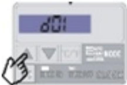
5. Taste »Modus« drücken, um den Wasserzulauf-Wert anzeigen zu lassen.
