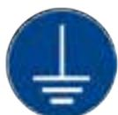
Es bestehen Gefahren durch elektrische Energie, wenn das Gerät oder elektrische Verbindungen nicht oder fehlerhaft geerdet werden.
