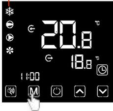
Drücken Sie kurz **M**, um den Modus kreisförmig umzuschalten. Nach 2 Sekunden ohne Bedienung wird der aktuelle Modus gespeichert.
