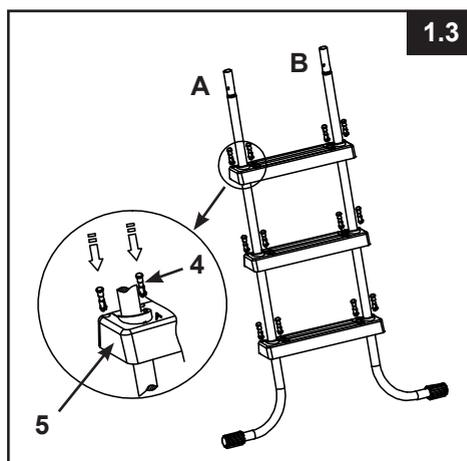
Drücken Sie die Montagedübel für die Sprossen in die Löcher um die Sprosse an der Montagebefestigung zu fixieren.
