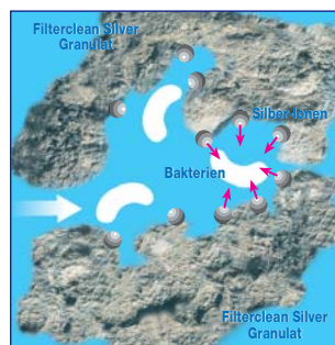
Bakterien werden in den Hohlräumen des Filtergranulats unschädlich gemacht.
